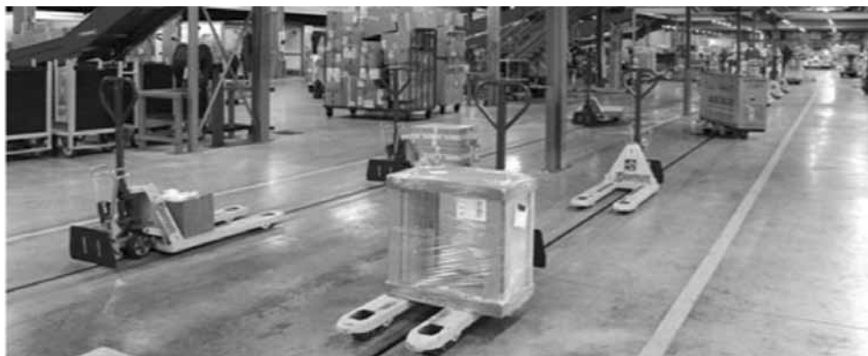
SLIKA 2. Konvejer s vučnim lancem u podu
